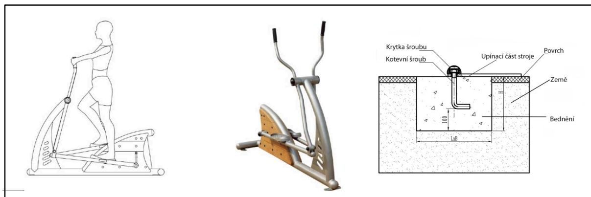
Obr. č. 10 – elipsovitě šlapadlo (pohledy a řez)
